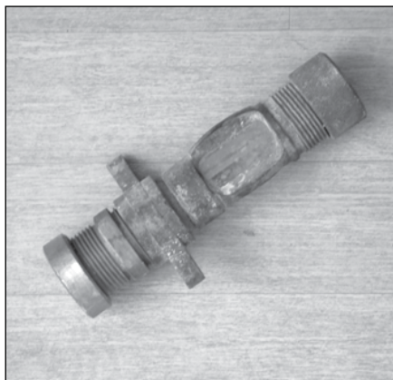
Nézőke Menetes vörösréz cső, üveg ab- lakkal. A gólyanyakra vagy más csőre szerelték. Hosszabbító ré- sze is van, ami hollander csavar- ral csatlakozik. Ezen keresztül figyelték a must/bor áramlását. Méretek: 26 x 14 x 6 cm
